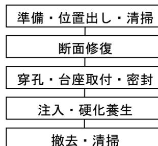
図 5.2.4 内圧充填工の施工フロー（例）
