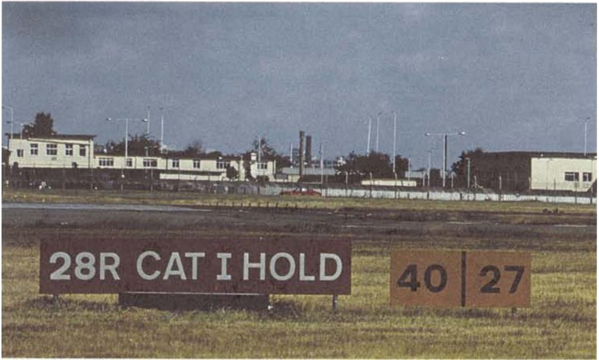
Hình A-2. Biển báo vị trí chờ lên đường cất hạ cánh phương thức tiếp cận CAT I đặt cạnh biển báo thông tin
