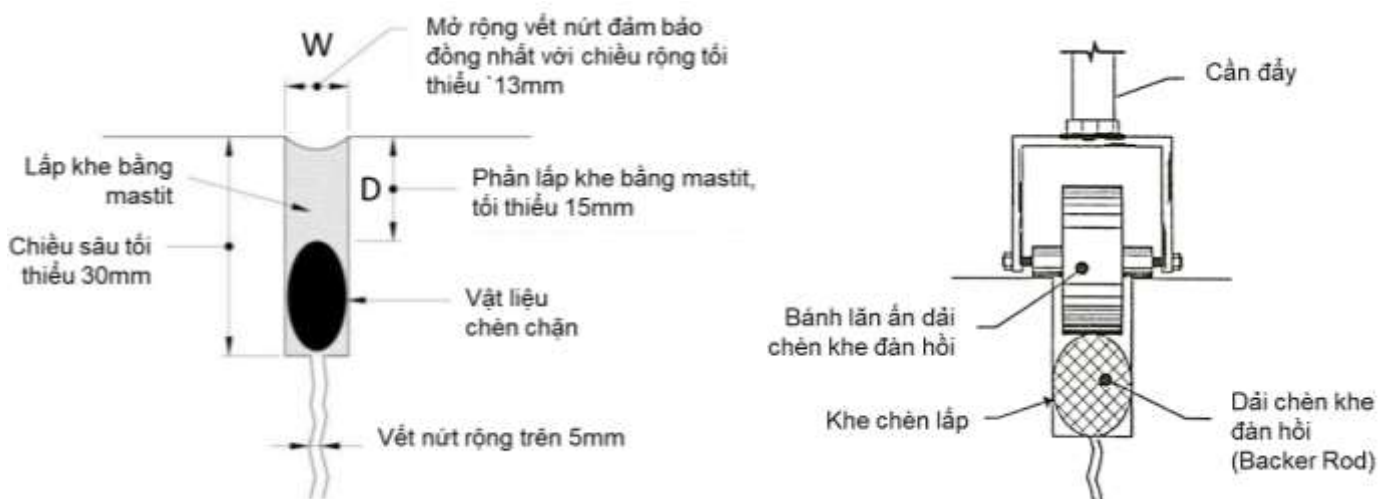
Hình 8 - Trám bít vết nứt vừa
