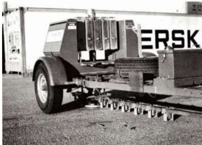
Hình 24 – Xác định vùng trống, hờ bên dưới đáy tấm bằng thiết bị đo độ võng
