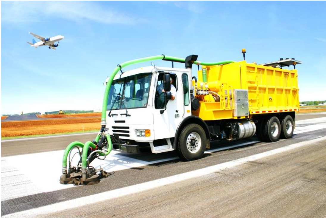
Ảnh 15 – Thiết bị sơn tẩy sơn mặt đường chuyên dụng
