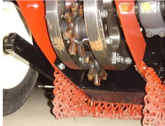
(b) Cấu tạo đầu mở rộng khe nứt
