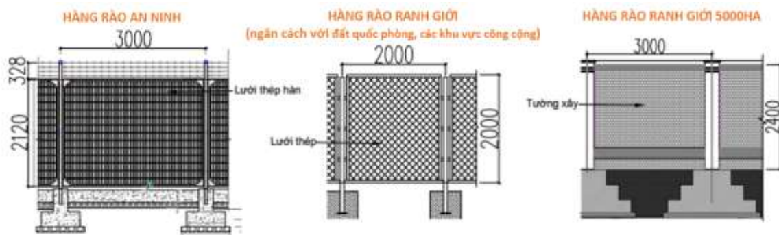
Hình 5.21 Mặt cắt ngang điển hình các tuyến hàng rào an ninh, ranh giới
