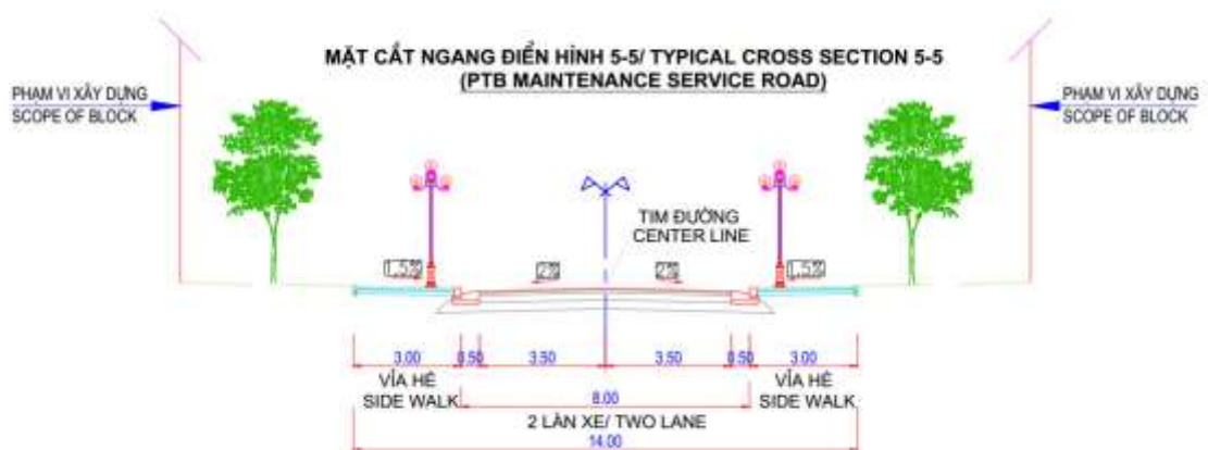
Hình 5.9: Mặt cắt ngang tuyến đường nội bộ (Mặt cắt 5-5)
