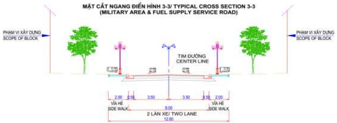
Hình 5.8: Mặt cắt ngang tuyến đường nội bộ (Mặt cắt 3-3)
