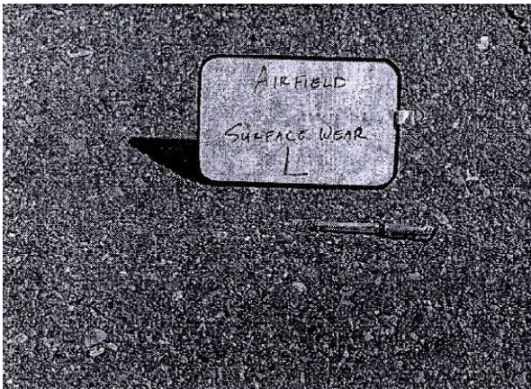
Hình A.79 – Lão hóa hư hỏng nhẹ (Hao mòn bề mặt)
