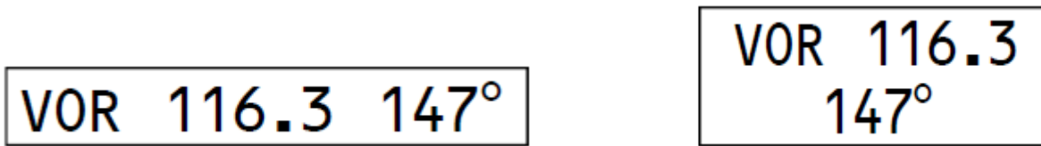
Hình 3 - Biển báo vị trí kiểm tra đài VOR (Khi không có DME kết hợp với VOR)
